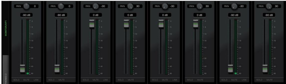
このセクションには「Monitor/HP1」、「Headphone 2」、「Line Out」という3つの16チャンネルバーチャルミキサーの各チャンネルのパンコントロール、ボリュームフェーダー、ソロ/ミュート/リンクボタンがあります。デフォルトでは 8 チャンネルが表示されています。ファンクションストリップ 3 の「Mixer」スイッチをクリックすると、8 チャンネルと 16 チャンネルの表示を切り替えることができます。
