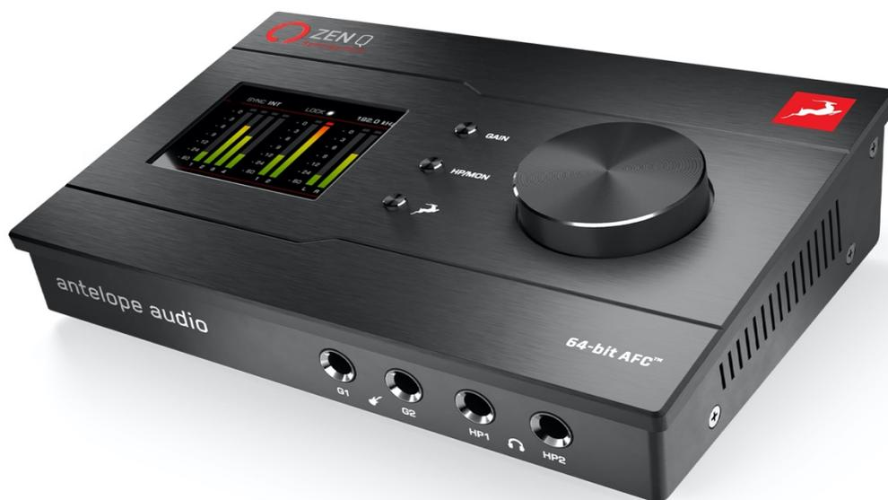
Zen Q Synergy Core のフロントパネルには切り替え可能な Line/Hi-Z 楽器入力（ラベルは「G1」と「G2」）と、ステレオヘッドフォン出力（ラベルは「HP1」と「HP2」）があります。ヘッドホン出力は、本体トップパネルの「HP/MON」ボタンや、Windows/macOSのコントロールパネルアプリケーションからアクセスできる専用のボリュームコントロールを備えています。
