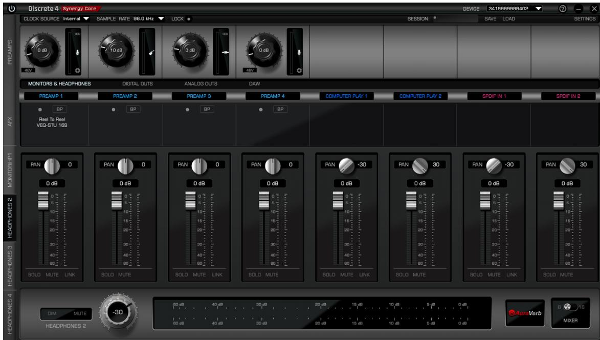
ソフトウェアコントロールパネルへようこそ！構造的には、従来の Antelope Audio コントロールパネルアプリケーションを簡素にデザインし直したものであるため、「EasyPanel」と呼びます。Discrete 4 Synergy Core のようなインターフェイスを直感的に操作できます。このデバイスでは、「ルーティングマトリックス」（スタジオパッチベイから派生）など、一部特殊な機能は小規模ユニットには適さないと感じました。
