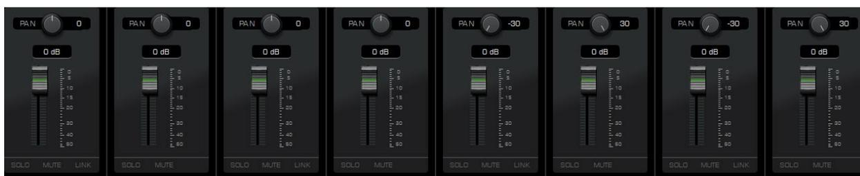
名为“**Monitor/HP1**”和“**Headphone 2**”的 2 个 16 通道软件调音台，每个通道的带有声像控制、音量推子和“**Solo/Mute/Link**”按钮。默认情况下，显示 8 个通道。点击功能条中的“**MIXER**”开关，可以在 8 通道和 16 通道之间切换。下图是调音台在 16 通道模式下的外观：
